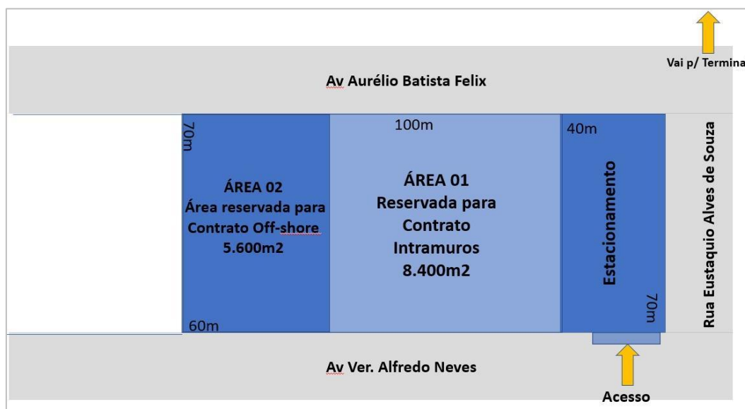
Figura 10: Indicação da fração de área disponível para o canteiro externo da obra intramuros.
