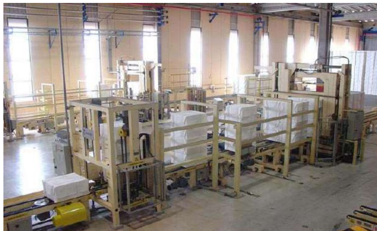
Figura 6 – Seção de prensagem e embalagem das folhas de celulose em fardos de 250 kg.
