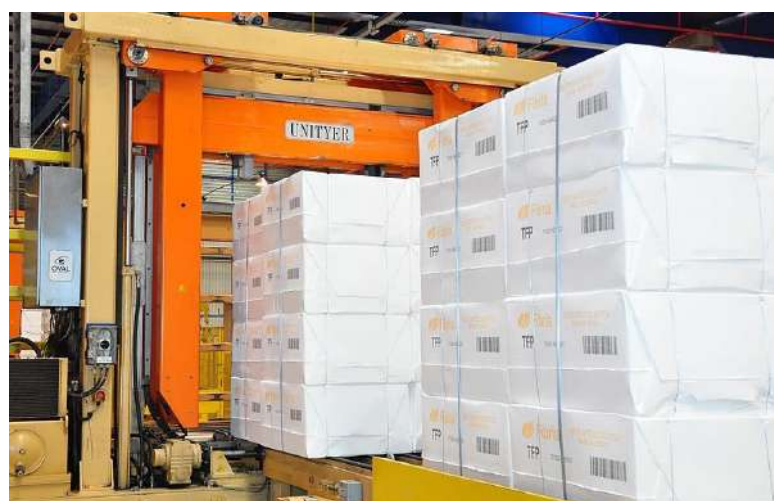
Figura 7 – Seção de agrupamento dos fardos de celulose formando uma unidade de transporte de 2.000 kg.
