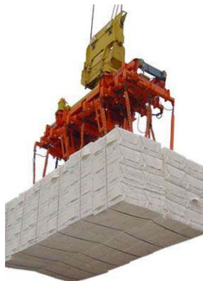
Figura 25 – Carregamento do navio utilizando guindastes ( Jib Crane ).
