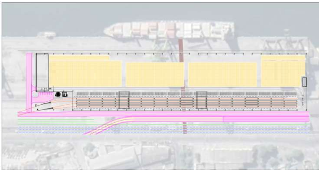
Figura 39 – Desmontagem da Parte Direita do Módulo de Vagões e Ocupação Total do Armazém Definitivo.
