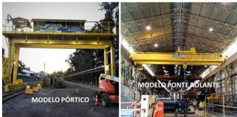
Figura 19 – Modelo de pórtico e ponte rolante
