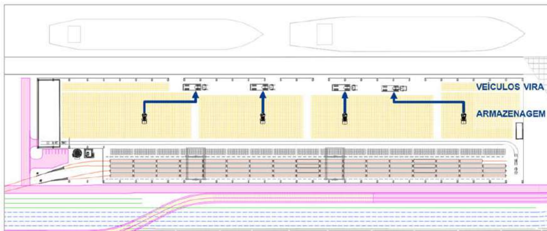
Figura 17 – Esquema do carregamento das carretas do vira
