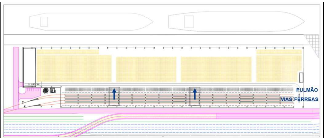
Figura 9 – Esquema de descarregamento de vagões
