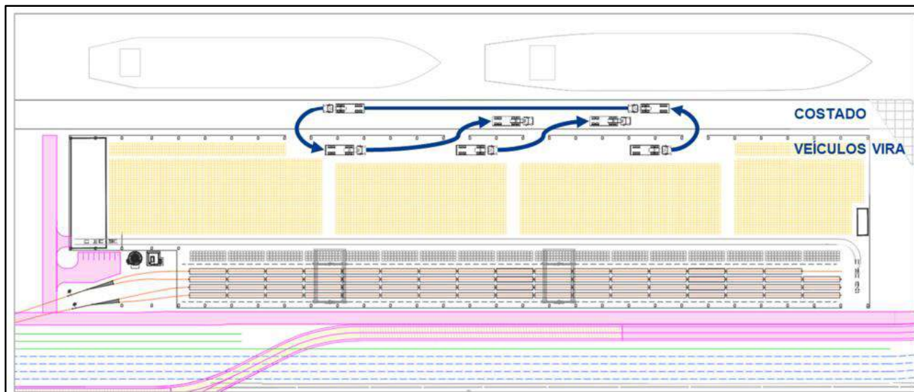
Figura 14 – Esquema geral da transferência para os navios
