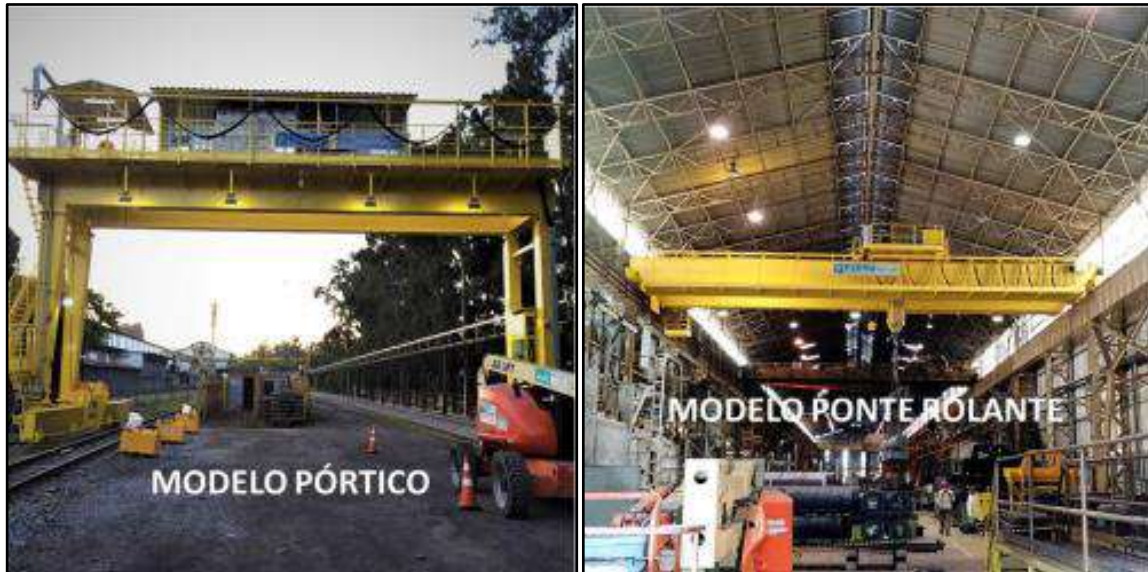
Figura 15 – Modelo de pórtico e ponte rolante
