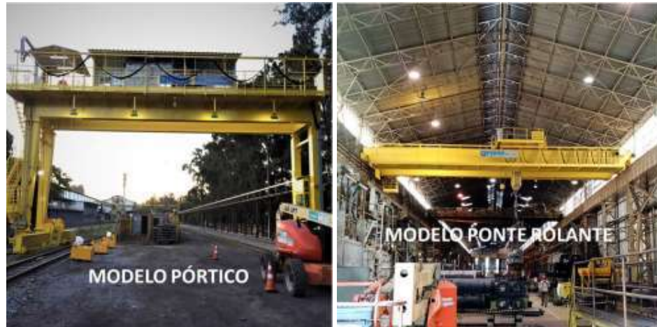
Figura 9 – Modelo de pórtico e ponte rolante.
