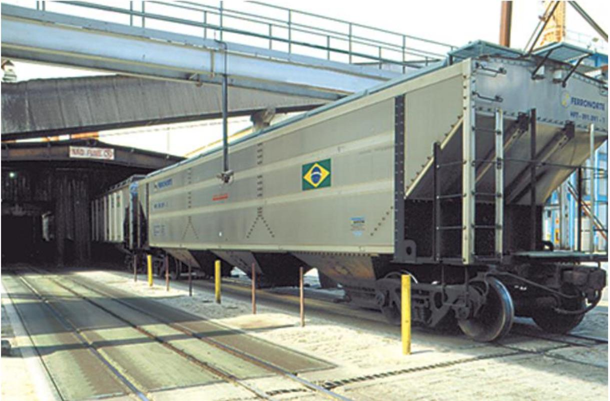
Figura 2.4.5.6-1: Balança Ferroviária tipo poço
