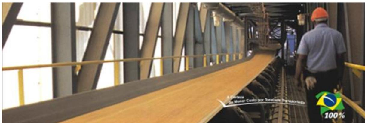
Figura 2.4.5.4-1: Transportador de Correia para Grãos em Galeria Fechada
