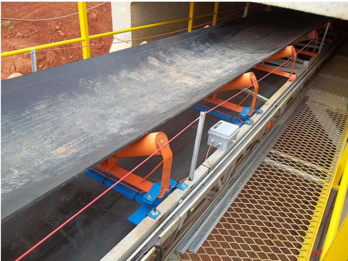
Figura 2.4.5.7-1: Balança Integradora/célula de carga nos roletes
