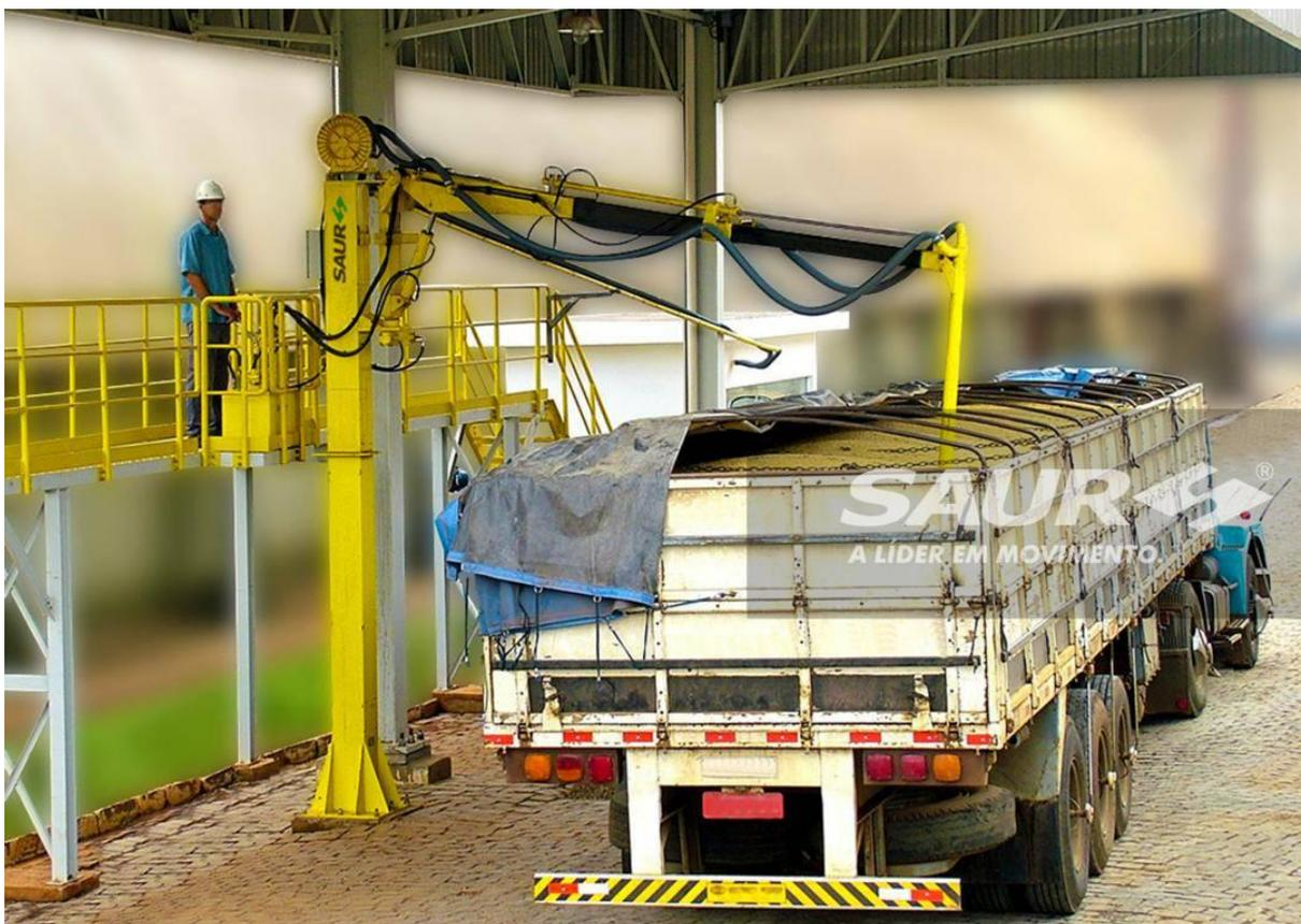
Figura 2.4.5.1-1: Coletor de Amostra
