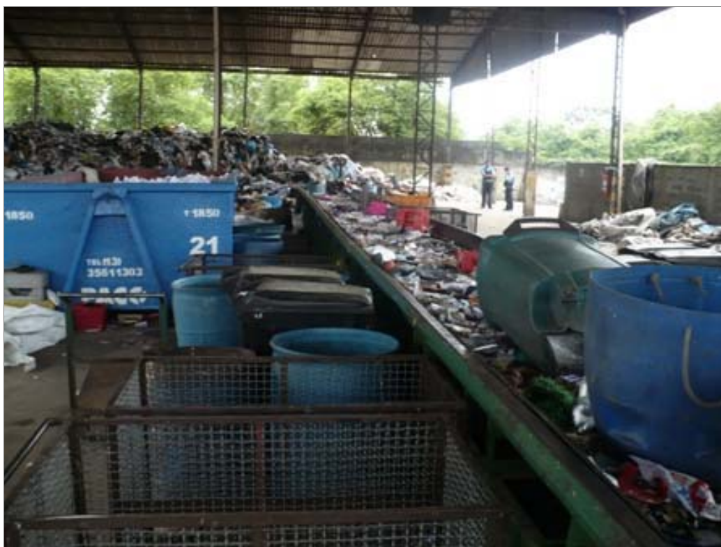
Figura 8.1 - Vista parcial da esteira de triagem no interior da usina. Fonte: Concremat.
