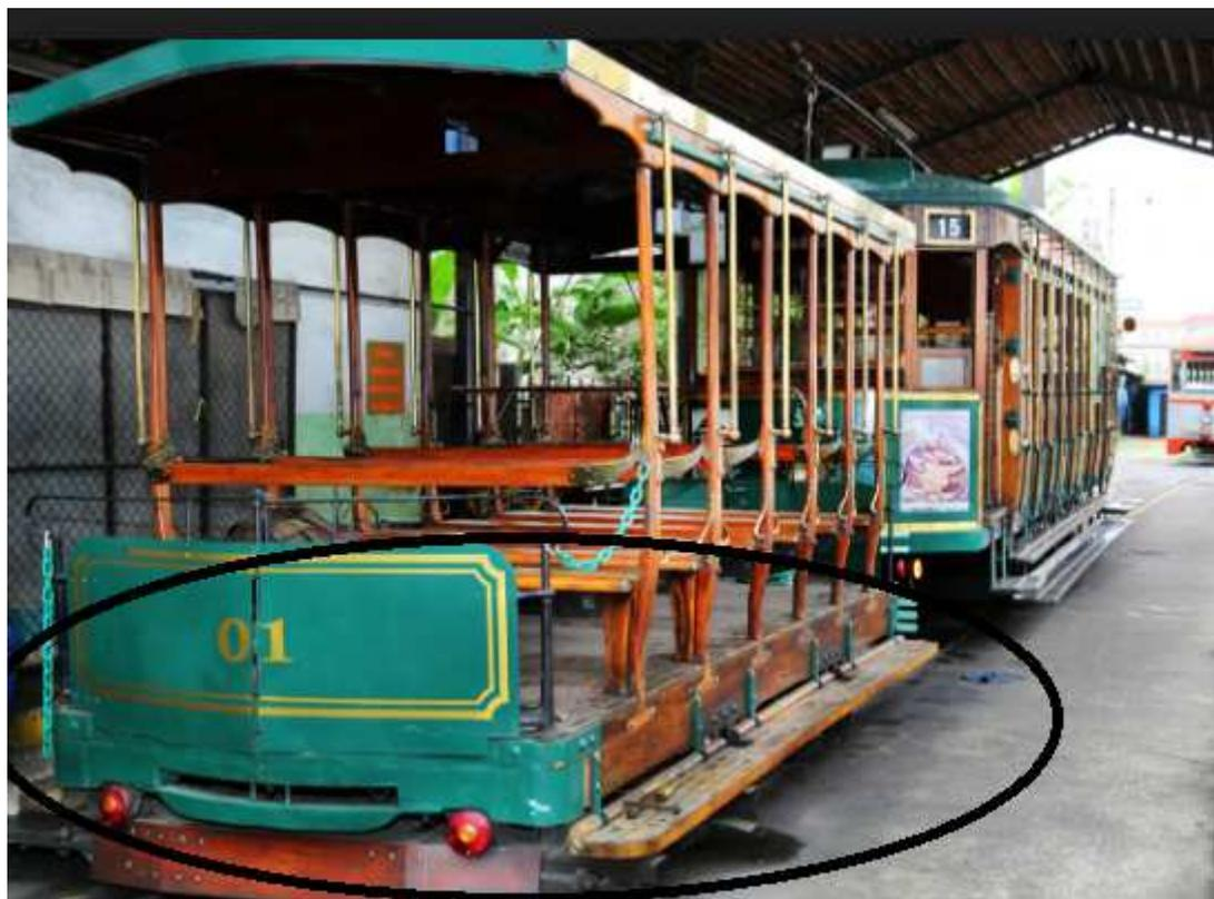
Rampa de acesso instalada na parte traseira do bonde capacidade duas cadeiras, fabricada internamente pela Cet-Santos
